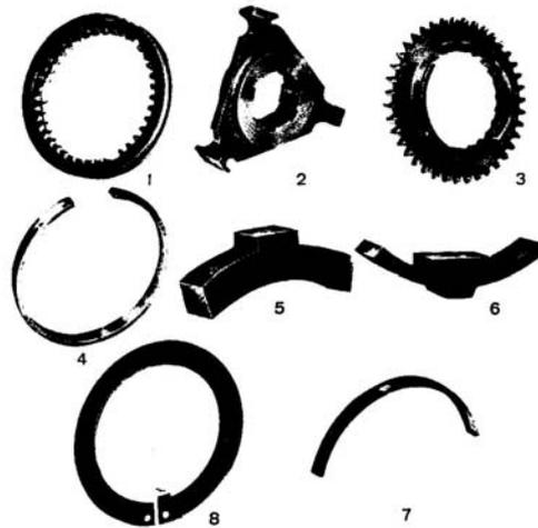
Figura 4-43 Componenti di un sincronizzatore Porsche
